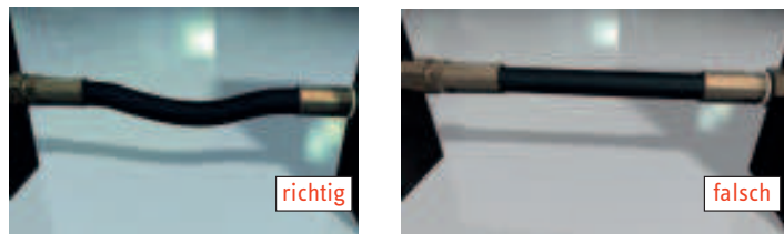
Abbildung 13: Einbaulänge
