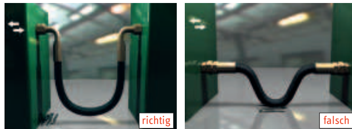
Abbildung 9: Vermeidung von Abrieb durch ausreichende Bewegungsfreiheit
